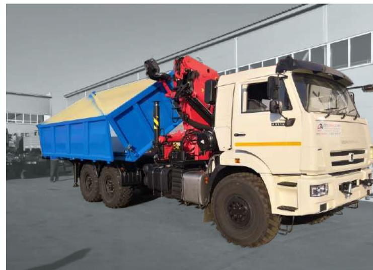
Самосвал КамАЗ с КМУ ИМ-320 с трехсторонней разгрузкой
