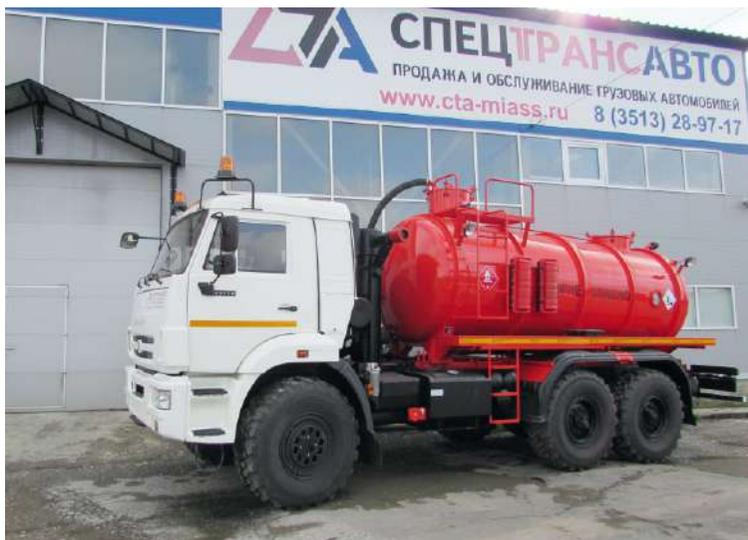
Автоцистерна вакуумная нефтепромысловая АKN-10 на шасси КамАЗ 43118 / Урал 4320
