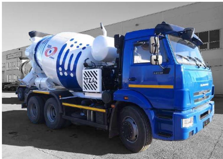
Автобетоносмеситель 58146Т на шасси КамАЗ
