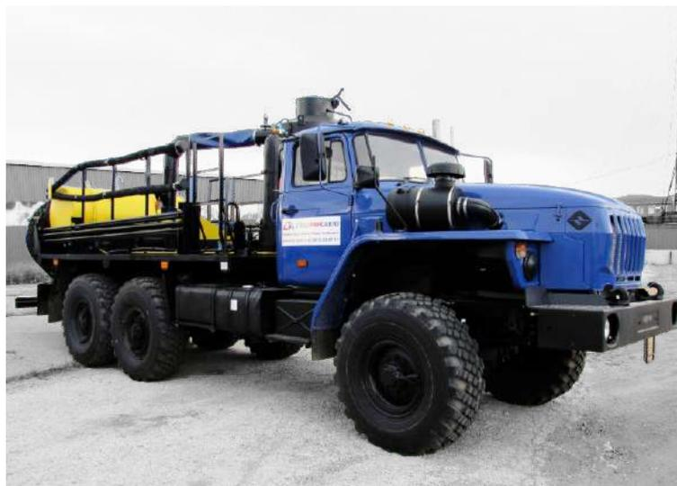
Агрегат АДПМ на базе Урал 4320/КамАЗ 43118
