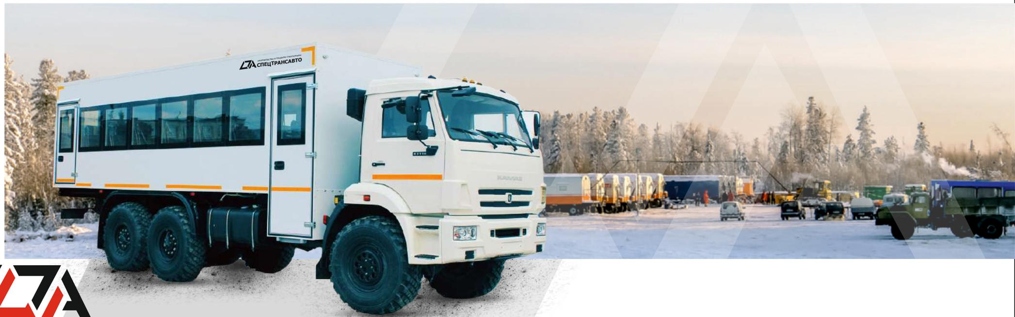
Вахтовый автобус для перевозки вахтовых смен, строительных бригад и команд специального назначения, на базе грузового полноприводного шасси, эксплуатируемый преимущественно в условиях бездорожья.
