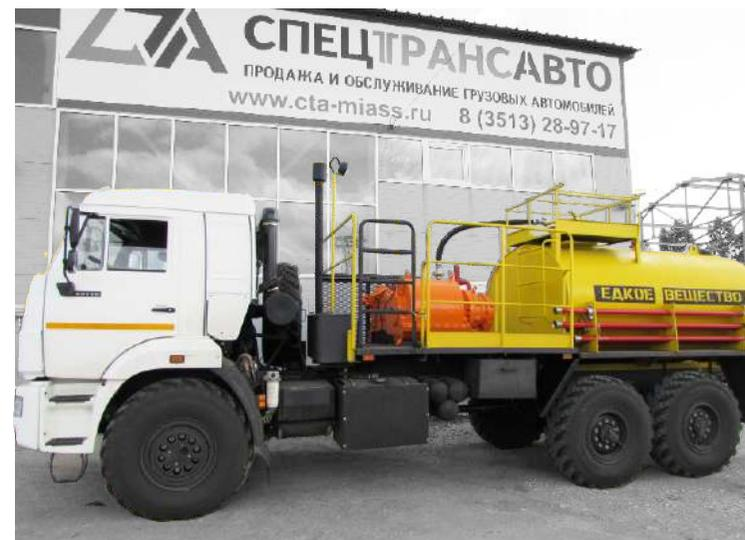
Установка для кислотной обработки скважин СИН-32 на базе Урал 4320/Камаз 43118
